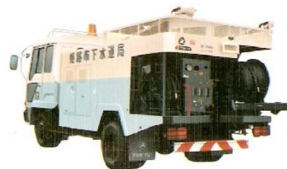
高圧下水管洗浄車
